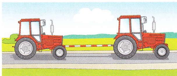
1. Неисправна рабочая тормозная система.
