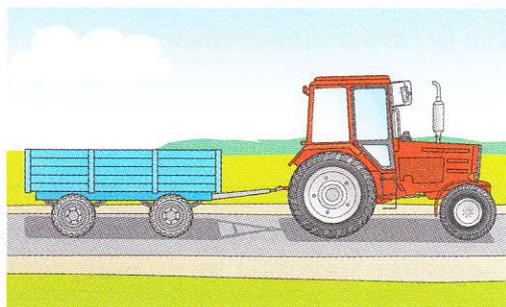
1. Торможение машины должно опережать торможение прицепа.
