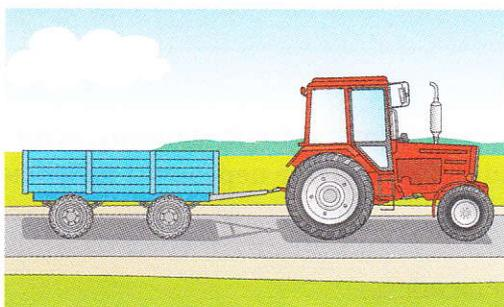
1. Торможение машины должно опережать торможение прицепа.
