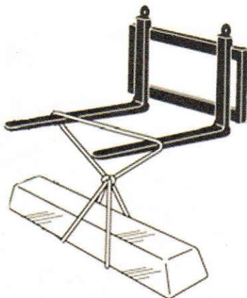
1. Разрешается при транспортировке на незначительное расстояние.
