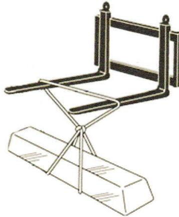
1. Разрешается при транспортировке на незначительное расстояние.
